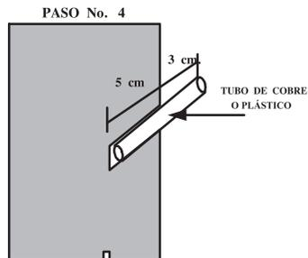
Vuelva a sopletear con aire a presión por medio de los tubos, para retirar el polvo interior y aplique sobre la fisura un cordón de **UNECRETO EPOXI PASTA** (adhesivo epóxico en pasta), una vez endurecido el adhesivo proceda al siguiente paso:
