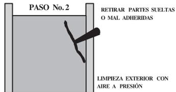
En grietas o fisuras verticales, sopletear con aire a presión para retirar partes flojas o sueltas. Sobre la grieta o fisura haga una perforación a cada 15 ó 20 cm. con una profundidad de 3 a 5 cm. con un diámetro de 1/4" ó 3/8" y con una inclinación de 15 positivos. Inserte tubos de cobre o de plástico en las perforaciones anteriores, quedando sobresalidos unos 3 cm.
