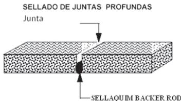
Se utiliza un cartucho de **JUNTACRIL SILICONIZADO** corte la punta en forma diagonal en el ancho deseado, con la ayuda de una navaja.
