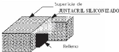
Tenga en cuenta que para asegurar la perfecta adherencia del **JUNTACRIL SILICONIZADO**, ninguna de las superficies formadas por las paredes de la cavidad deben medir menos de 5 mm. De ancho o peralte. En caso contrario amplíe la junta con una herramienta adecuada.
